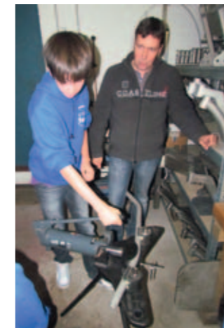
Rohre biegen und Fußrasten drücken bei BBS
